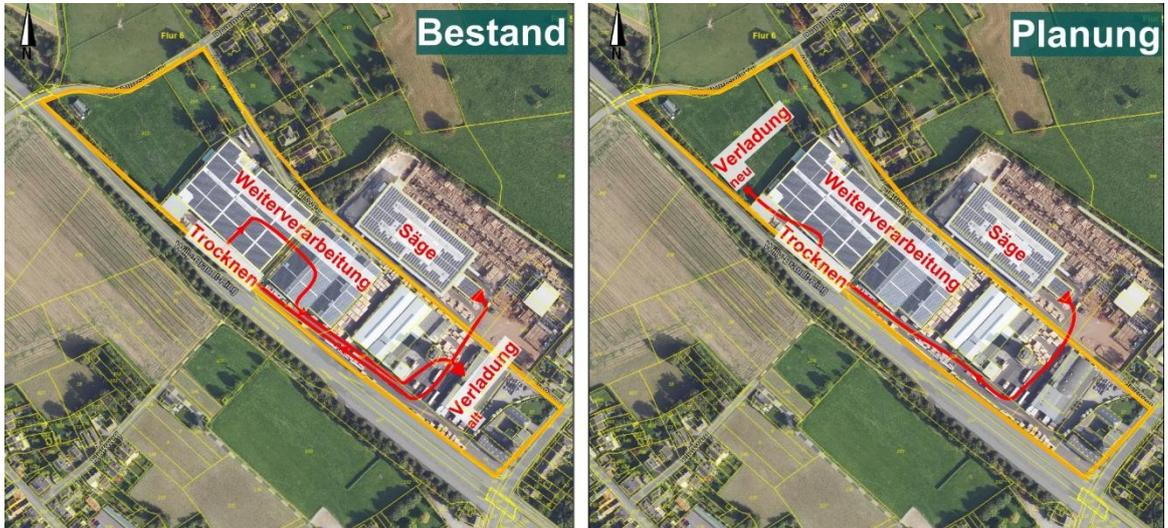
Abbildung 4: Vorgesehene Betriebsabläufe des Holzverarbeitungsbetriebes (eigene Darstellung VDH Projektmanagement GmbH)
