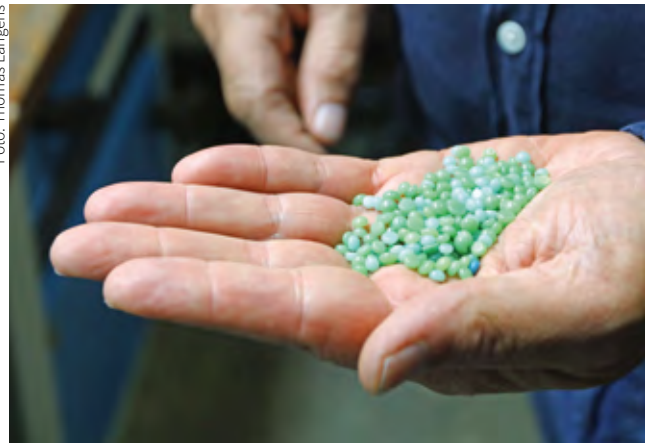
Aus diesem Wachsg- granulat werden die Modelle hergestellt.
